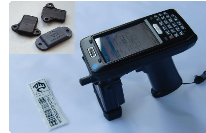
Ein RFID-Lesegerät (großes Bild) und drei RFID-Transponder (links oben), wie sie im Projekt verwendet wurden. Fotos: dpm, Simon
