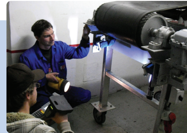
Test der RFID-Funktionsfähigkeit am Gurtreiniger eines Förderbands. Foto: HS Lausitz
