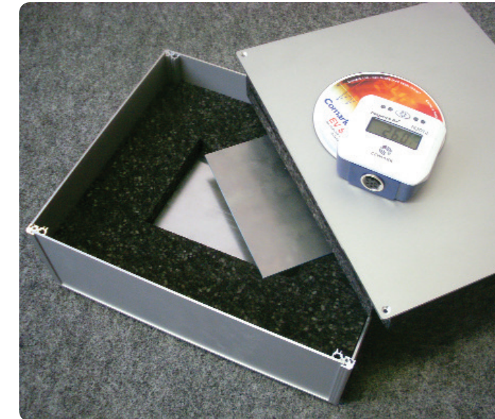
Das Drei-Schicht-Kalorimeter mit der Außenhülle und dem Probenbehälter, jeweils aus Aluminium, mit dazwischen liegendem Isolationsmaterial. Abgebildet sind zudem eine Messeinheit und die CD der Auswertungssoftware. Foto: w & a
