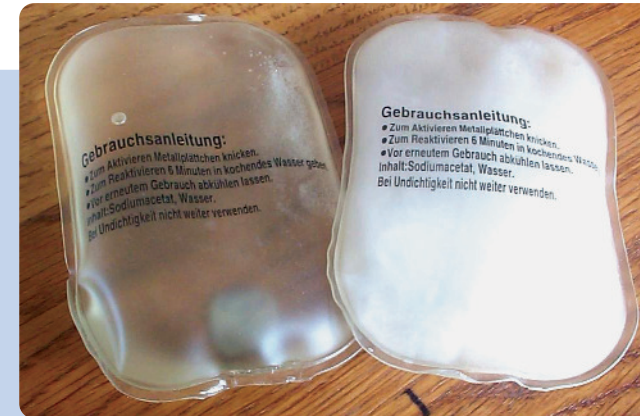
Phasenwechselmaterialien (PCM) werden beispielsweise bei Handwärmern eingesetzt, links im flüssigen, rechts im kristallisierten Zustand. Foto: Wikipedia
