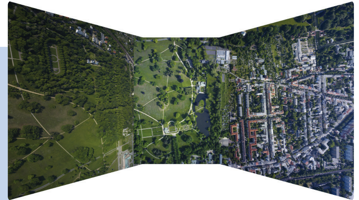
Ein Bildertripel des Schrägbildsystems AOS, zu einem Bild zusammengesetzt. Zu sehen ist die Stadt Potsdam. Foto/Montage: BSF Swissphoto
