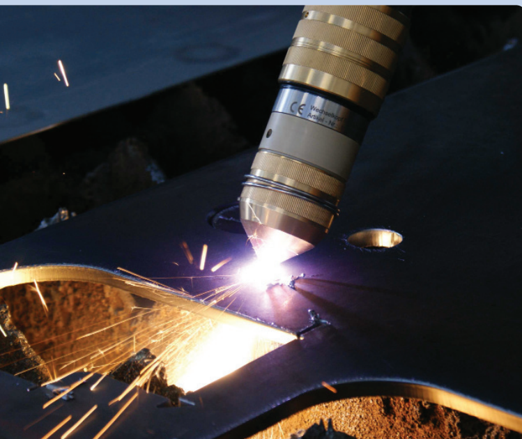
Fasen mit der Technik des Plasmaschneidens.
